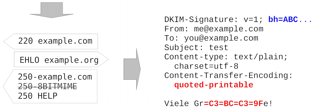
Abbildung 8: Wenn der empfangende Mail-Server kein 8BITMIME unterstützt, muss die Mail passend umkodiert werden. Dieses invalidiert die DKIM-Signatur.
