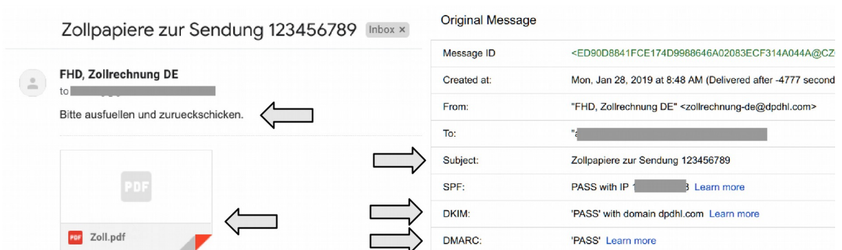
Abbildung 6: Darstellung in Gmail - Subject und Inhalt sind verändert und neue Anhänge hinzugefügt. DKIM und DMARC sind aber weiterhin PASS.
